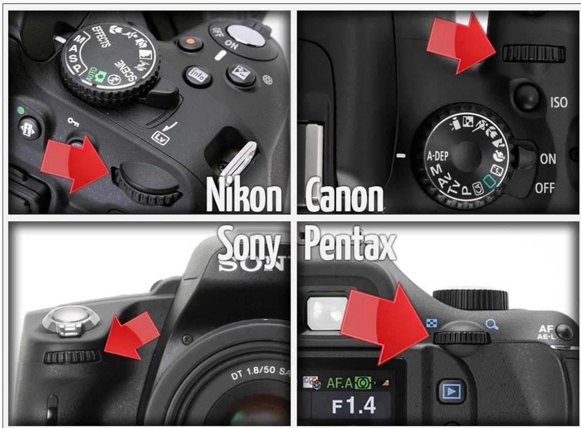
En el modo semimanual no hay pérdida, el dial de control permite modificar el ajuste que hayas seleccionado. Si has escogido el modo de Apertura, controlarás la Apertura, si por el contrario has seleccionado el modo Velocidad, será ésta la que manejes.
